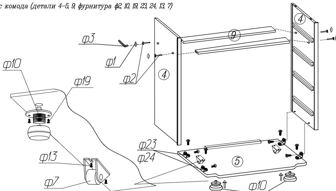
4 Установите крышку в сборе, используя фурнитуру (ф23, ф24)
